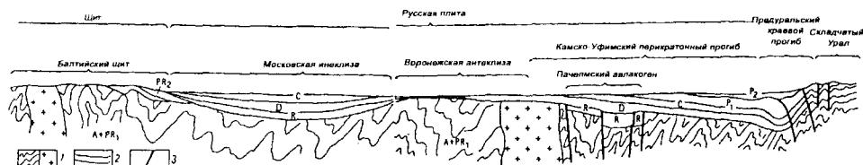
Рис. 8.6. Схема главных элементов строения древней платформы на примере Восточно-Европейской платформы (по М. В. Муратову): 1 — кристаллический фундамент платформы; 2 — доплитный (рифей) и плитный (девон, карбон, пермь) комплексы; 3 — разломы
