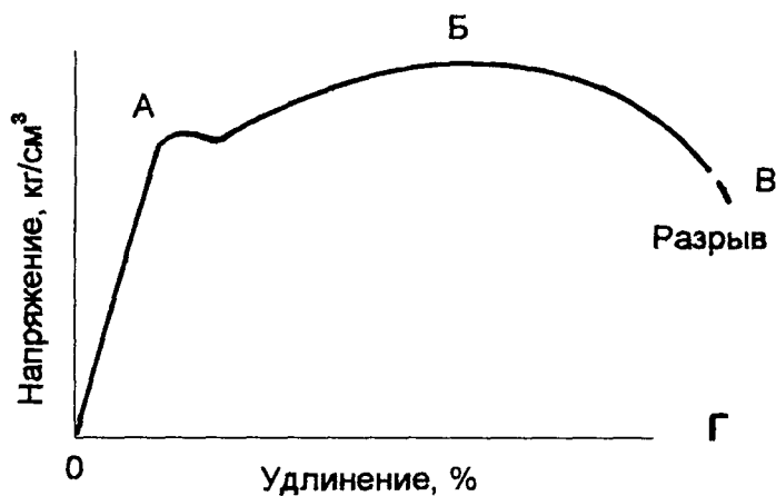
Рис. 9.2. Кривая деформаций. ОА — упругая деформация; АВ — пластическая деформация; БВ — деформация при ослабленном теле перед разрывом
