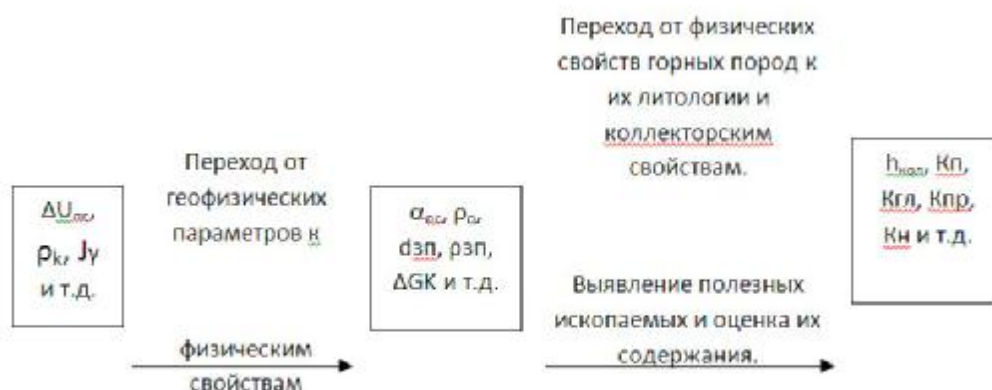
Рис.2. Схема интерпретации данных геофизических исследований скважин [1].
