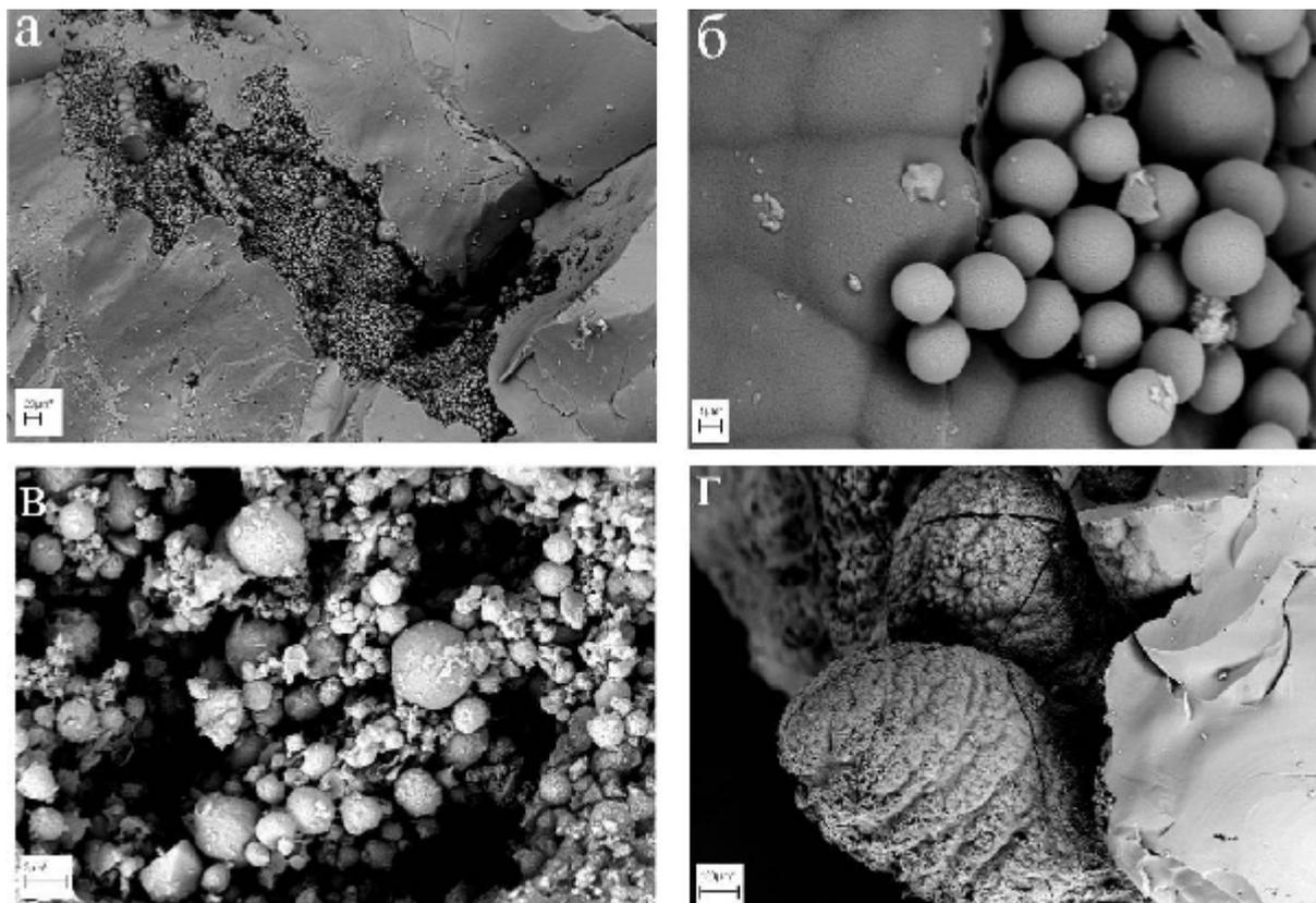
Рис. 3. Микрофотографии техногенных отложений Мутновского геотермального: а - глобулярное строение двуоксида кремния ( $\text{SiO}_2$ ) и троилита ( $\text{FeS}$ ); б - наночастицы двуоксида кремния ( $\text{SiO}_2$ ); в - фрагменты микроструктуры техногенных новообразований; г- микростроение сульфидных агрегатов. Фото - сканирующий электронный микроскоп.
