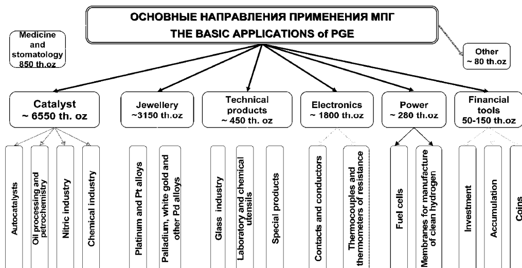
Рис. 1. Основные области применения (с округленным объемом потребления в тройских унциях) элементов платиновой группы в начале XXI века[2].
