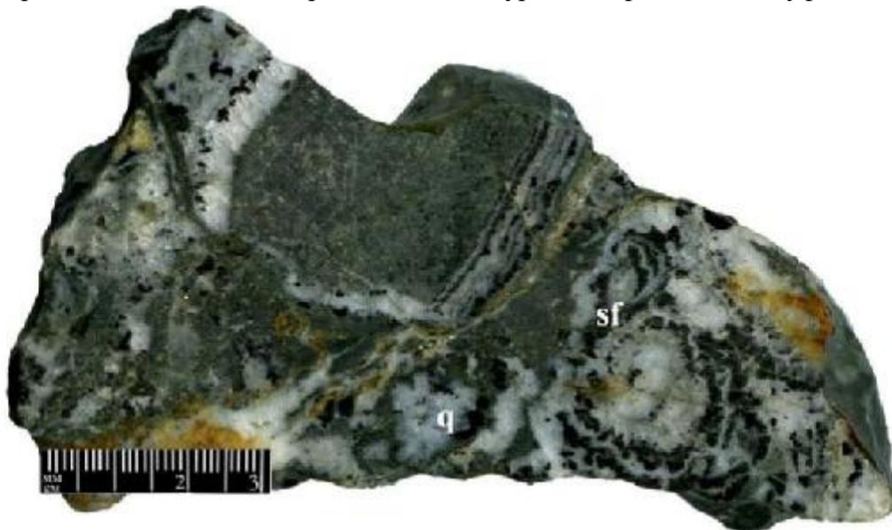
Рис. 1 в. Друзовидная текстура с элементами брекчиевидной и крустификационно-полосчатой. Полированный штуф.
