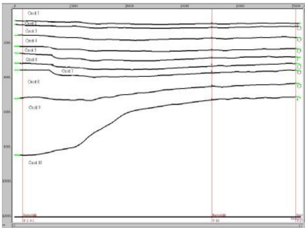
Рис. 3. Окончательная глубинно-скоростная модель.
