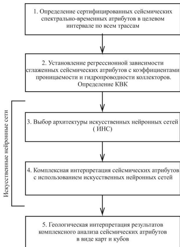
Рис.3. Блок схема методики определения коэффициента проницаемости коллекторов
