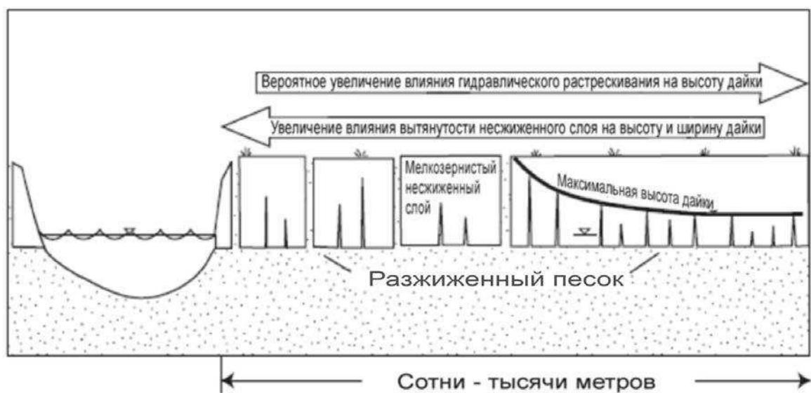
**Рис. 1.8.** Вертикальный разрез вблизи берега водотока, показывающий идеализированные влияния бокового растекания и гидравлического растрескивания (по [Obermeier et al., 2005]).
