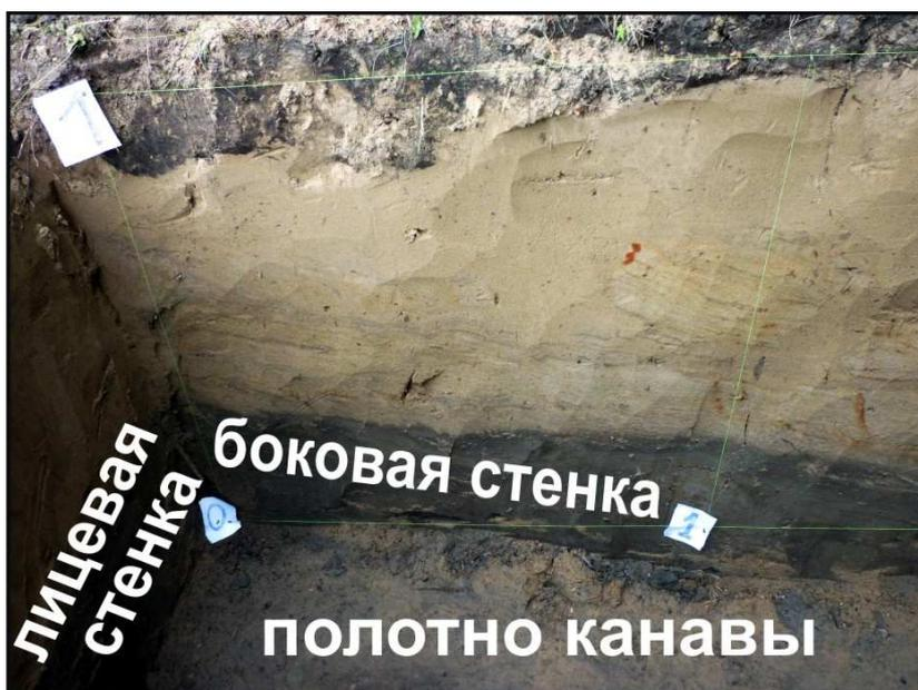
**Рис. 2.1.** Фрагмент боковой стенки канавы, подготовленной для детальной документации
