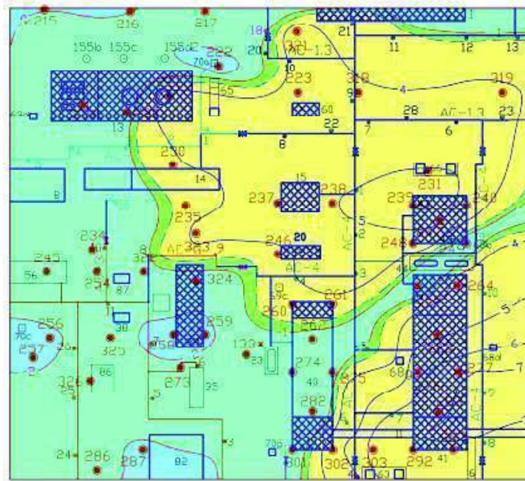
Рис. 3.1.2 Фрагмент схемы сооружений с системой термостабилизации по территории УКПГ в зависимости от начальных инженерно-геокриологических условий и условий эксплуатации
