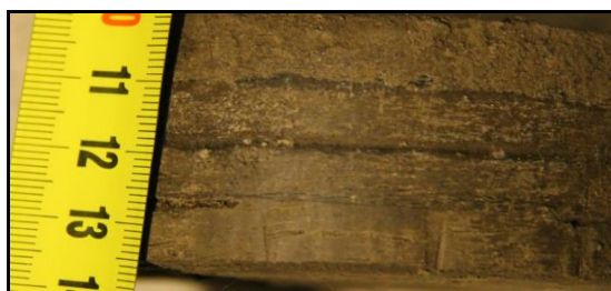
Рисунок 3.4. Образец супеси со слоистой криогенной текстурой (3 шлира).
