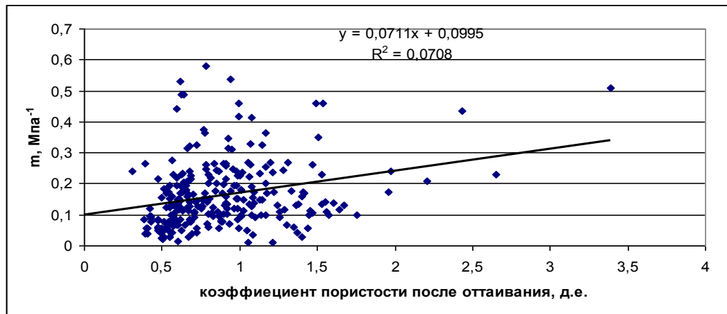
Рисунок 6.7. Зависимость коэффициента сжимаемости от коэффициента пористости после оттаивания суглинка.
