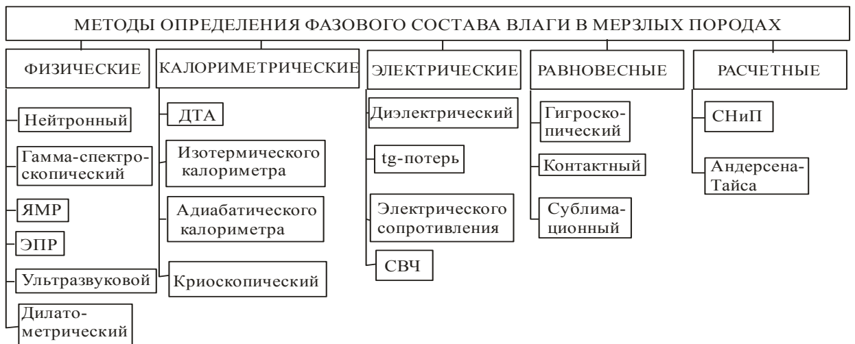
Рис. 2-2 Классификация методов определения фазового состава влаги в мерзлых породах (Комаров, 2003) .
