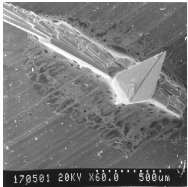
Рис.3.22. Срастание кристаллов несоизмерной фазы с монокристаллами тенорита (CuO).
