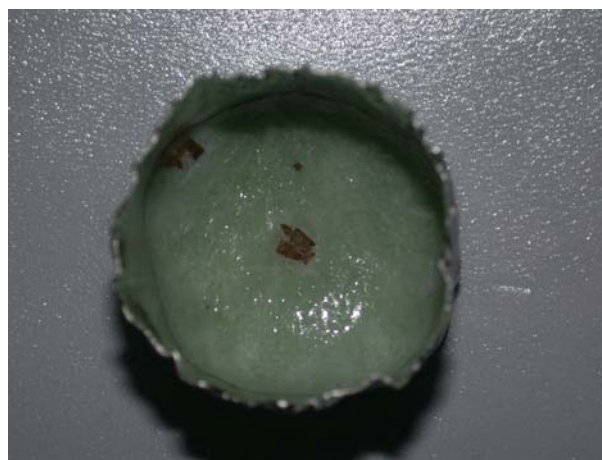
Рис.4.43. Кристаллы КТР; \text{K}_6\text{P}_4\text{O}_{13} : \text{Na}_2\text{SO}_4 = 7 : 1 . Ув.х2.
