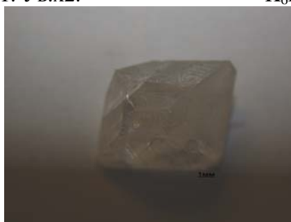
Рис.4.43. Кристаллы КТР; \text{K}_6\text{P}_4\text{O}_{13} : \text{Na}_2\text{SO}_4 = 7 : 1 . Ув.х2.
