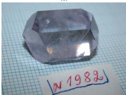
Рис.5.12. Монокристаллы итрий- и гадолиний-алюминиевых боратов, легированные р.з.э. а - Yb (опыт 1626); б-к - Yb и Er (опыты 1639, 1867, 1886, 1946, 1969, 1980, 1982, 2024, 2054).
