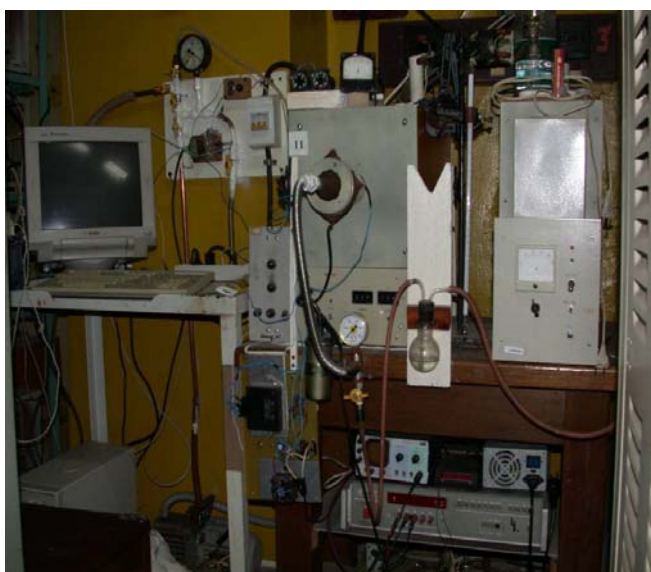
Рис.2.4. Оборудование для кристаллизации ванадатов: печь и оборудование для управления газовой средой.
