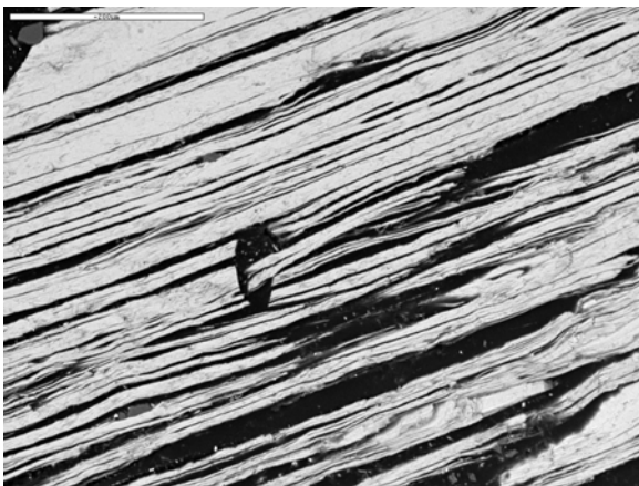
Рис.4.31. Слоистый агрегат \text{CuGeO}_3 с 0.5% Fe, шкала 200мкм.
