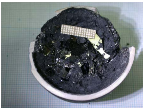
Рис. 2.1. Пластинчатые кристаллы 123, образовавшиеся на поверхности расплава.
