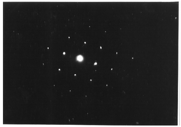
Рис.3.11. Дифракционная картина, полученной под просвечивающим электронным микроскопом для фаз типа Vi-2212. а - наличие спутанных рефлексов; б - отсутствие спутанных рефлексов.
