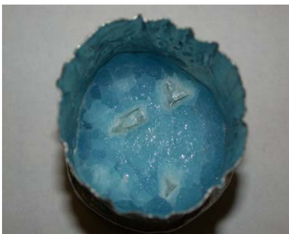
Рис.4.42. Кристаллы КТР; \text{K}_6\text{P}_4\text{O}_{13} : \text{Li}_2\text{SO}_4 = 4 : 1 . Ув.х2.
