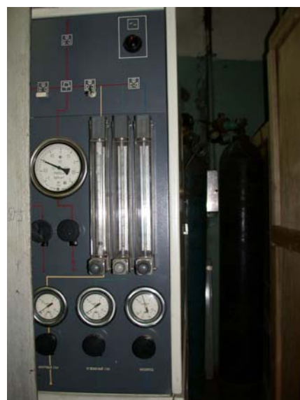
Рис.2.5. Установка для управления подачей газа Кристалл-3М.
