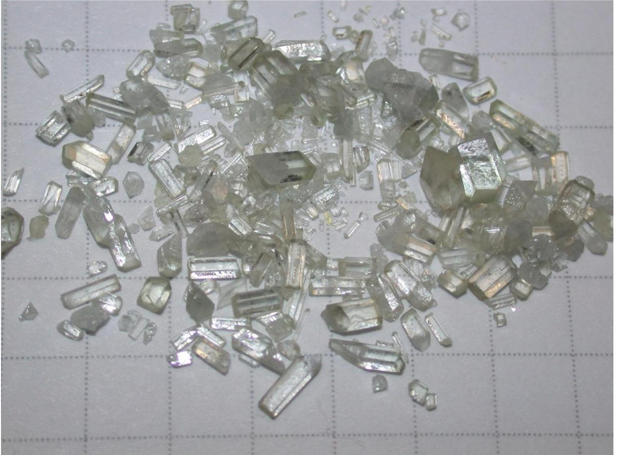
Рис. 1: Монокристаллы  $Gd (Yb, Er)Al_3(BO_3)_4$ , полученные в результате спонтанной кристаллизации
