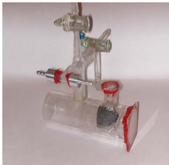
Рис.1. Фото вакуумной камеры с образцом. Металлические цилиндры – датчики давления. Над образцом – флюоритовый иллюминатор.
