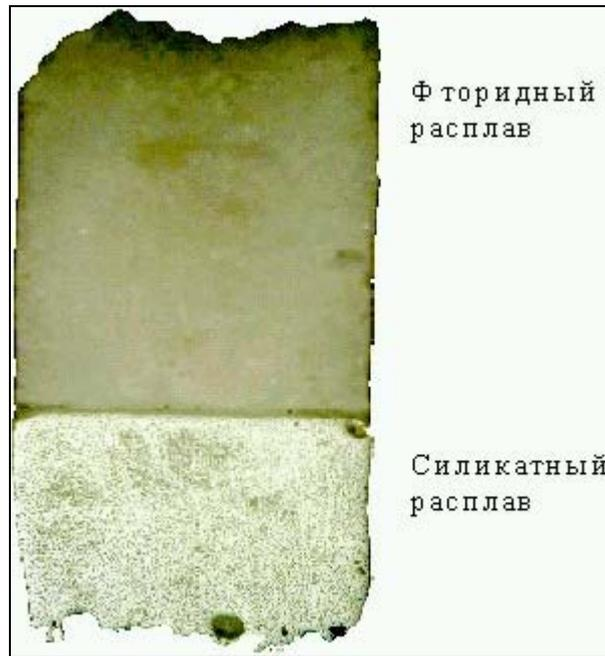
Рис. 4. Вид образца после центрифугирования
