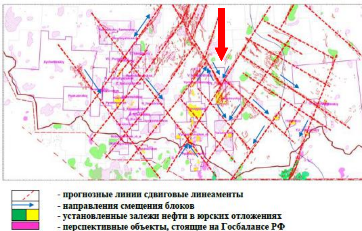
Рис.4. Схема генерализованной зональной системы сдвиговых дислокаций Пур-Тазовского междуречья
